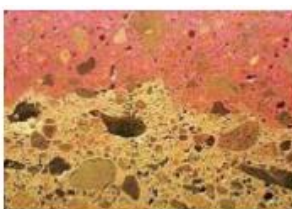
A Controll®Innerseal behatolási mélysége (piros pigmentáció).
